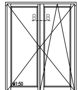
Bei Stulpelementen wird aus Gründen der Beschlagsmontage immer Schwelle MFT-101727206 verwendet; s. Zeichnung-Nr. 01-IV68-SC/08
