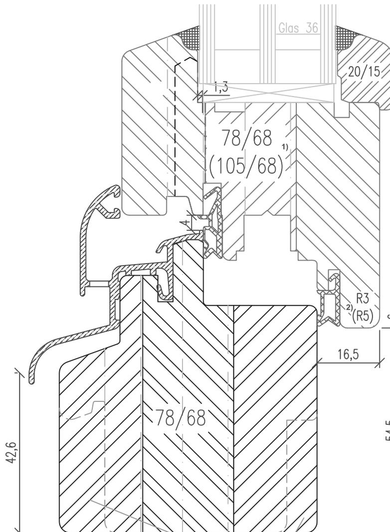
Glasleiste profiliert für Glasstärken 24mm bis 34mm
