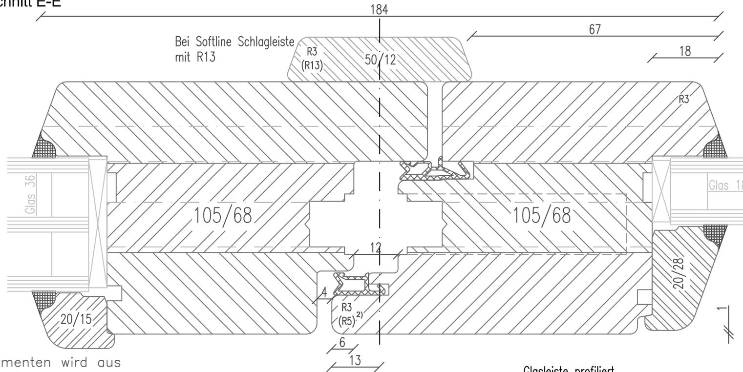
Bei Stulpelementen wird aus Gründen der Beschlagsmontage immer Schwelle MFT-101727206 verwendet; s. Zeichnung-Nr. 01-IV68-SC/08
